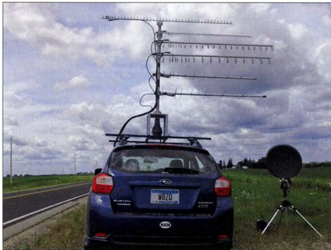
Bild 1: Mobilstation von Jon, WØZQ, mit Antennen für 2 m, 1,25 m (220 MHz), 70 cm, 33 cm (902 MHz), 13 cm und 23 cm
