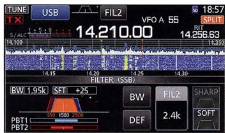
Bild 25: Die komfortable Darstellung der Twin-PBT-Einstellung des SSB-Filters 2; über die große Schaltfläche mit FIL2/2,4 kHz lassen sich die Filter schnell durchblättern.
