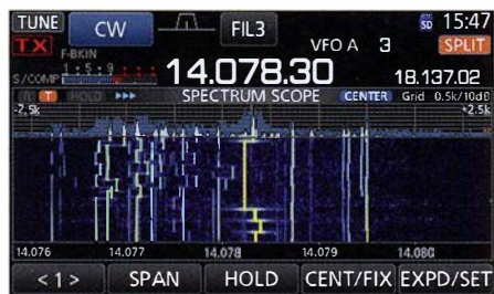
Bild 19: Auch im Amateurband findet man ungewöhnliche Signale. So etwas tummelt sich etwas oberhalb des 20-m-PSK-Bereichs.
