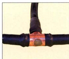
Bild 8: Selbst gebauter Koaxialkabel-T-Verbinder
