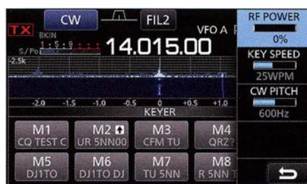
Bild 13: Ein Druck auf den Multi -Knopf zaubert in fast allen Fällen ein zur Betriebssituation passendes Kontextmenü hervor.
