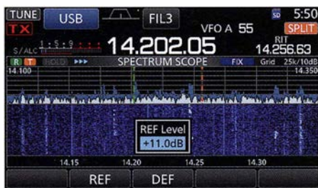
Bild 18: Der grüne Marker zeigt bei Split die Empfangs-, der orange die Sendefrequenz. Mit dem Abstimmknopf verändert man den Referenzpegel für den Wasserfall.
