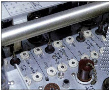
Bild 8: Induktive Abstimmbrücke für die HF- und Treiberkreise des KWM-2 Fotos: DJ6HP
