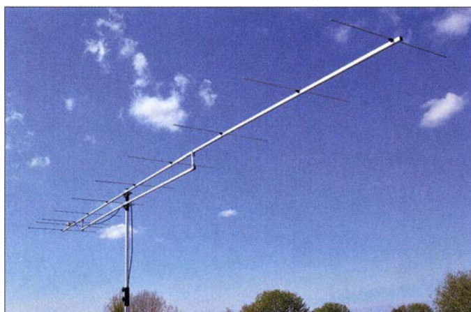
Bild 1: Fertig montierte 10-Element-Yagi-Antenne während eines Tests; bei der späteren Endmontage sollten jedoch vier Verbinder zwischen Boom und Unterzug eingesetzt werden.
