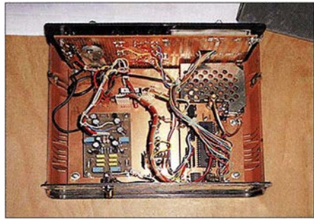
HF-Generator mit zuschaltbarem Zweitonmodulator und RC-Gliedern als NF-Signalquellen
