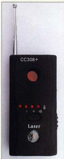
Der CC308+ spürt Funk-sender in der Nähe auf.
