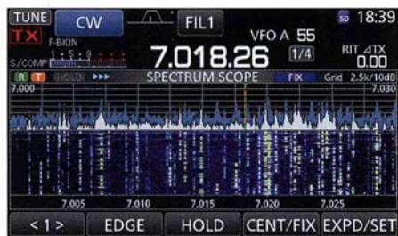
Bild 17: CW-Bandbelegung im recht eng eingestellten Fix-Modus beim IARU-Region-1-Fieldday 2016; der doppelfarbige Marker signalisiert: kein Split.
