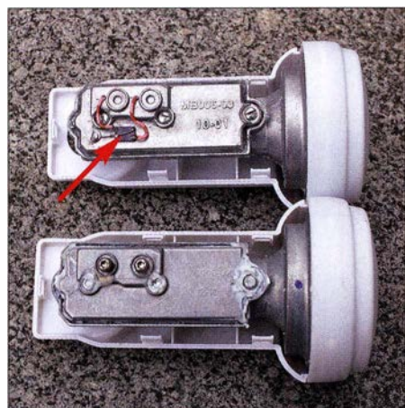
Bild 12: Montierter Quarz im MQ-Gehäuse; Befestigung über Massepads mittels Schaltdraht und M2-Schraube (Pfeil); unten ein Vorläufermodell mit Abgleichschrauben für die dielektrischen Resonatoren
