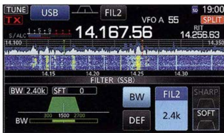
Bild 26: Über BW gelangt man zu dieser Darstellung; hier kann man die Sollbandbreiten aller Filter per Abstimmknopf festlegen und sie auch speichern.
