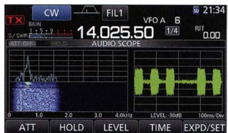
Bild 22: Das Audioskop arbeitet im NF-Bereich und benutzt für Spektrumgramm und Wasserfall eine feste Bandbreite.
