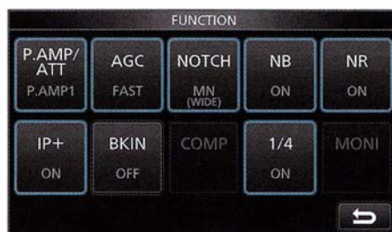
Bild 15: Im Funktionsmenü lassen sich Einstellungen wichtiger Bedienelemente kontrollieren und ändern.
