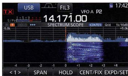
Bild 20: Dieses SSB-Signal überträgt sauber eingeeignet ein NF-Band von etwa 100 Hz bis 2,8 kHz, also mit 2,7 kHz Bandbreite.
