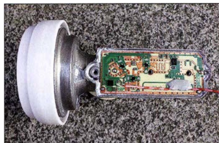
Bild 11: Fixierung der Anschlusslitzen für den Quarz mit Klebstoff
