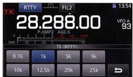
Bild 24: Langes Tippen auf die Kilohertz-Stelle bringt dieses Menü zur Auswahl der Schrittweite auf den Bildschirm.
